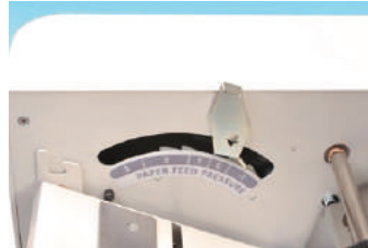
El ajuste de la presión de alimentación ayuda a la máquina a trabajar con mayor variedad de pilas de papel.
